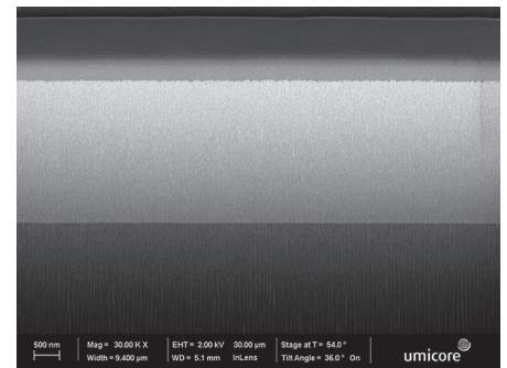
Eine gleichmäßige und homogene Gold-Eisen-Schicht abgeschieden aus AURUNA® 8000 im FIB-Schnitt (Bild: Umicore MDS)
