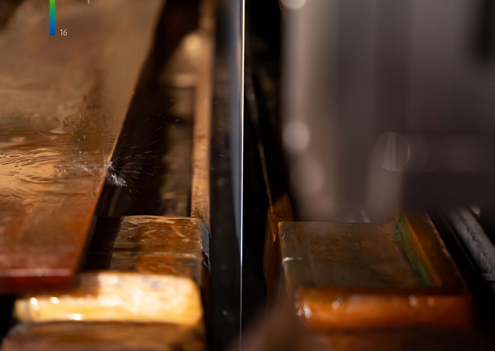
Im Herzen der Bandgalvanik: Ein Stahlband durchläuft eine Verzinkungszelle.
