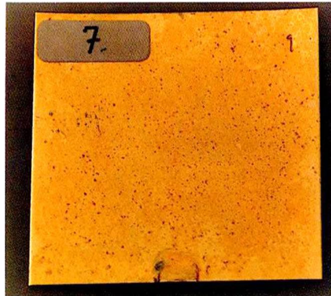
Abb. 11c: 0,5 µm Auruna®311 auf Glanznickel über Edelstahl Nr. 14301 – III C. Test: 2 Tage besprüht mit reinem Wasser von 55 °C.
