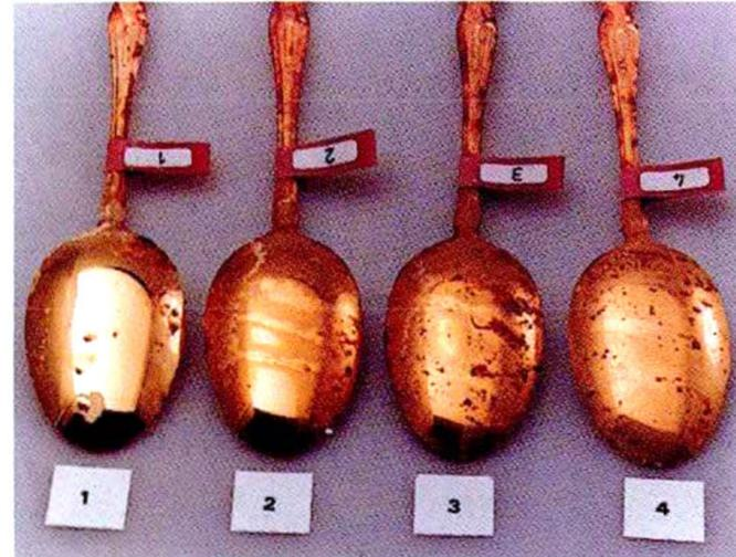
Abb. 9b: Goldauflage mit Schichtdicke  $0,2 \mu\text{m}$  auf Werkstoff Nr. 14401. Test: Salzsprühstest DIN 50021,  $35^\circ\text{C}$ , 2 Tage.
