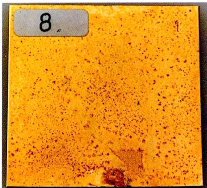
Abb. 11d: 0,5 µm Vergoldung Auruna® 539 LC (Citrattyp) auf Glanznickel über Edelstahl Nr. 14301 – III C. Test: 2 Tage besprüht mit reinem Wasser von 55 °C.
