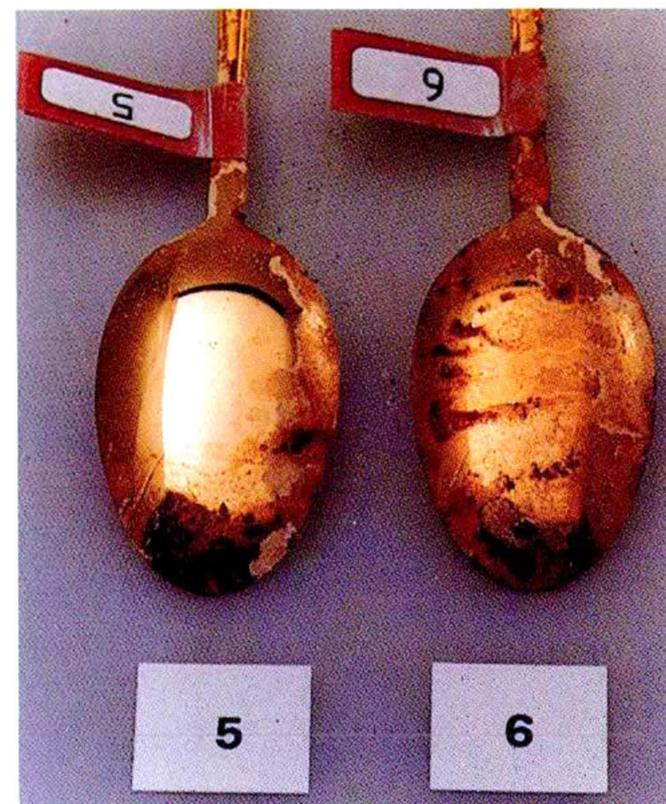
Abb. 10b: Goldauflage mit Schichtdicke  $0,5 \mu\text{m}$  auf Werkstoff Nr. 14401. Test: Salzsprühstest DIN 50021,  $35^\circ\text{C}$ , 2 Tage.
