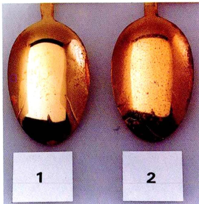
Abb. 9a: Goldauflage mit Schichtdicke  $0,2 \mu\text{m}$  auf Werkstoff Nr. 14401. Test: 2 Tage besprüht mit reinem Wasser von  $55^\circ\text{C}$ .
