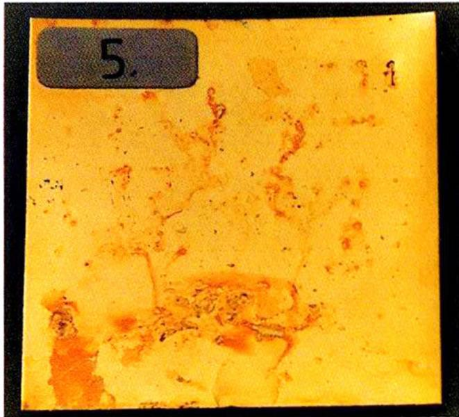
Abb. 11a: 0,5 µm Direktvergoldung auf Werkstoff Nr. 14301 – III C. Test: 2 Tage besprüht mit reinem Wasser von 55 °C.
