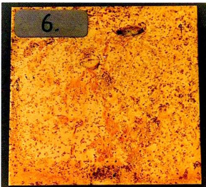
Abb. 11b: 0,5 µm Vergoldung (Citrattyp) mit Ni-strike auf Werkstoff Nr. 14301 – III C. Test: 2 Tage besprüht mit reinem Wasser von 55 °C.
