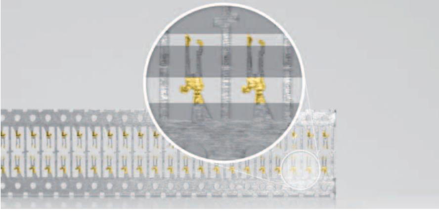
Reduzierter Goldverbrauch durch scharfe Randabgrenzung am Beispiel eines FPC (Flexible Printed Circuit)-Steckers.
