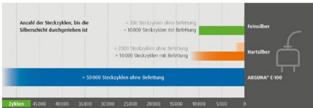
Selbst nach über 50.000 Steckzyklen ist eine intakte Silbergrafitschicht nachweisbar
