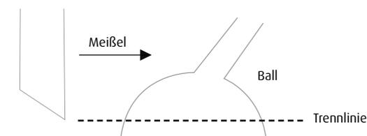
Scherkräfte, Messung der Ball-Seite, Ball-Wedge-Bonden auf Leadframe. Au-Draht 33 µm, K&S-Gerät, Fmin > 50 cN, x (Soll) 70 - 90 cN
