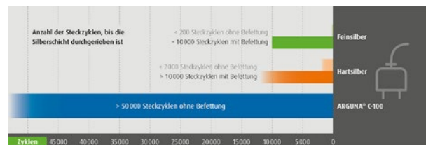
Selbst nach über 50.000 Steckzyklen® ist eine intakte Silbergraphitschicht nachweisbar
